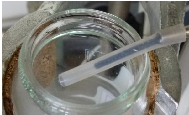
Abb. 7-2: Aus dem Nachreaktionsrohr zwischenzeitlich austretende klare Flüssigkeit, gefolgt von feststoffhaltiger Dispersion
