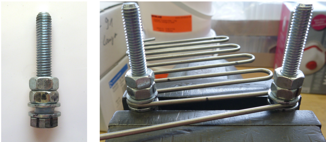
Abb. 4-5: Improvisiertes Biegewerkzeug für dünnwandige Rohre mit geringem Durchmesser, das für den betreffenden Rohrdurchmesser exakt justiert werden kann (links: gemäß Rohrdurchmesser justierbares Biegeelement; rechts: Biegen eines Rohres mit Hilfe von 2 in einem Schraubstock fixierten Biegeelementen)
