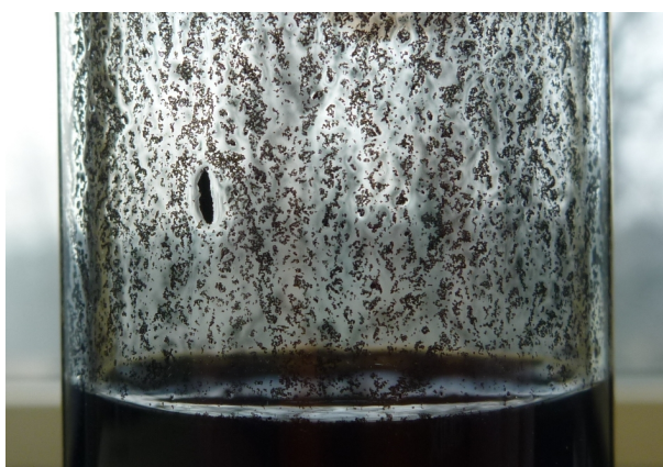
Abb. 7-1: Agglomeriertes Produkt an der Wandung des Auffangbehälters (Durchmesser des Auffangbehälters ca. 33 mm)
